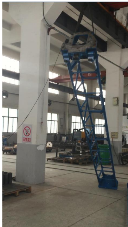
图 9 旋挖钻机垂直度检测项目
