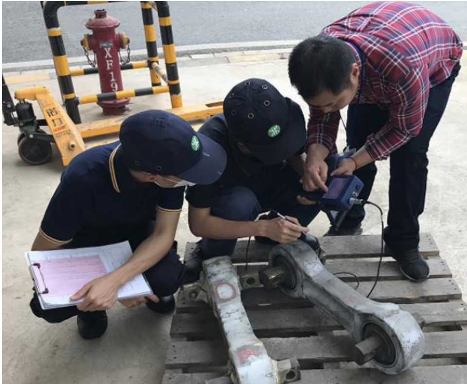
图 2 企业结对师傅对学徒进行涡流检测指导
