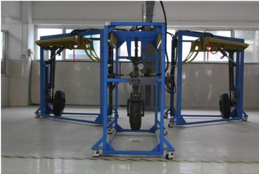
图3 歼-8型飞机完整起落架收放系统
