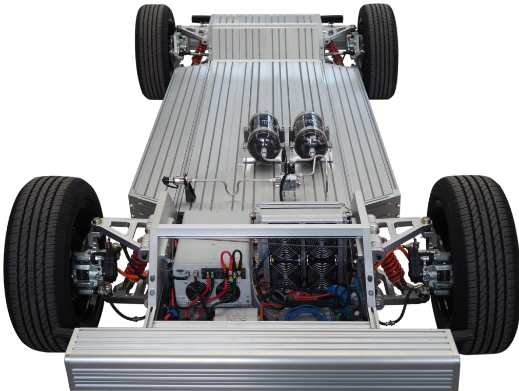
图 4 氢燃料混合动力教学平台
