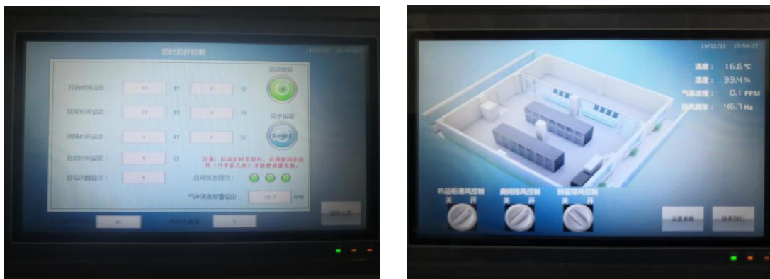
图 22 学院实验与计算中心药品试剂库智能通风控制系统
