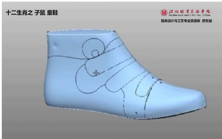
图 12 帮面款式结构线设计
